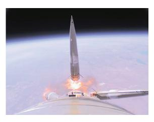
Рис. 12. Пуск РН «Союз-ФГ» с ТПК «Союз МС-10» 11.10.2018, космодром Байконур, нештатное отделение I ступени
