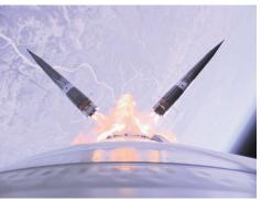
Рис. 8. Пуск РН «Союз-2.1а» с КА «Канопус-В» № 3 и № 4 01.02.2018, космодром Восточный, отделение I ступени
