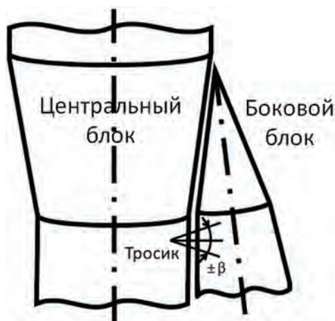
Рис. 1. Схема соединения тросиком бокового блока с центральным блоком
